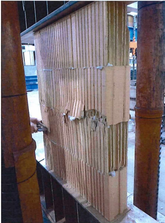
Photo 12 : Mur D5 après rupture
