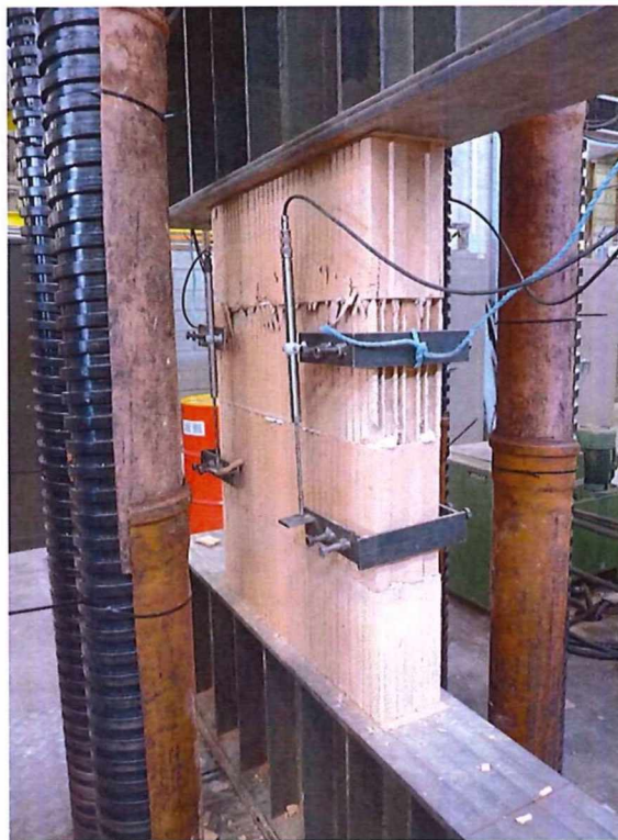
Photo 10 : Mur D3 après rupture
