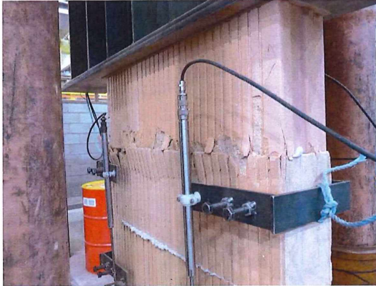
Photo 9 : Mur D2 après rupture
