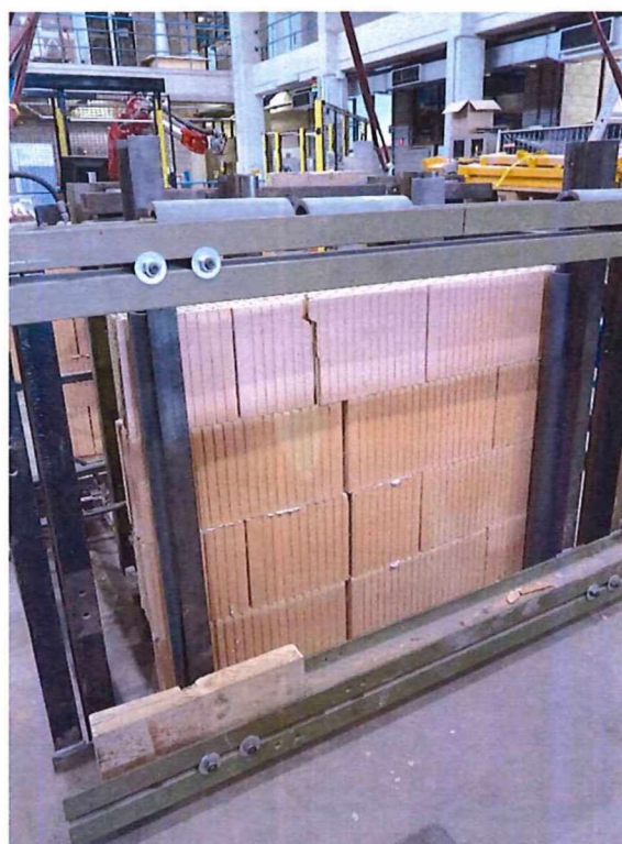
Photo 9 : BH3 après rupture
