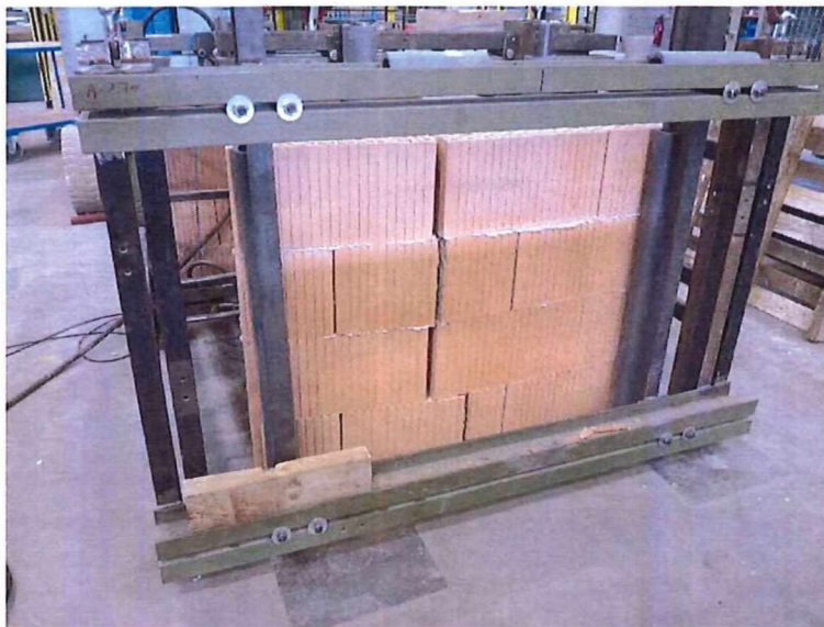
Photo 8 : BH2 après rupture
