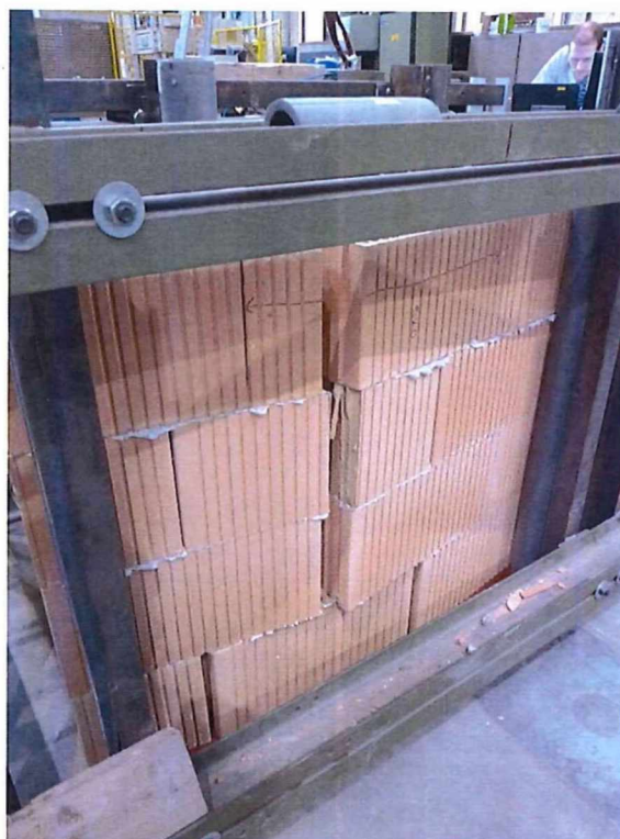
Photo 7 : BH1 après rupture
